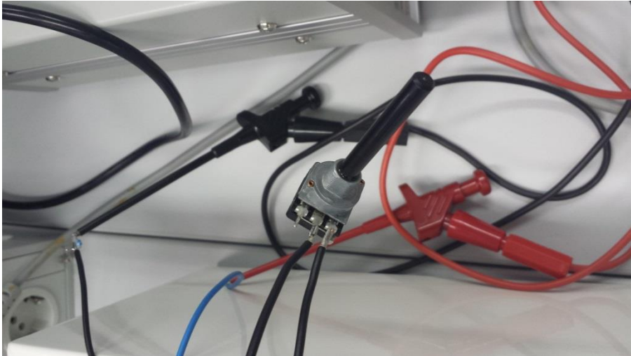
Abbildung 7: Simulation des Pt100-Fühlers
